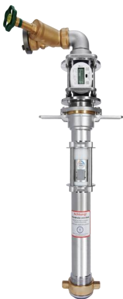
STU-Standrohr BAendo408 komplett mit integriertem Systemtrenner Absperrventil seitlich Anschluss C-Kupplung Ultraschallzähler W1 Q3=40 mit NB-IoT
