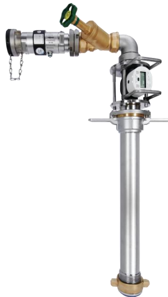
STU-Standrohr komplett mit Systemtrenner BA VO199 am Ausgang flexibel montiert (optional auch starr verbaut) Absperrventil seitlich Anschluss C-Kupplung Ultraschallzähler W1 Q3=40 mit NB-IoT
