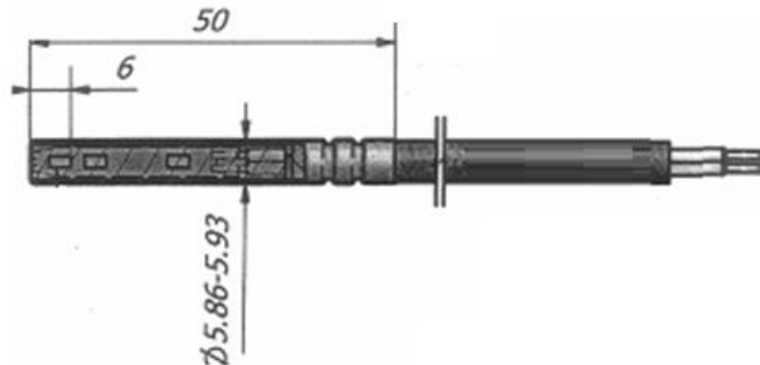
Fig. B3.2 Gesamtabmessungen des Temperaturfühler vom Typ PL
