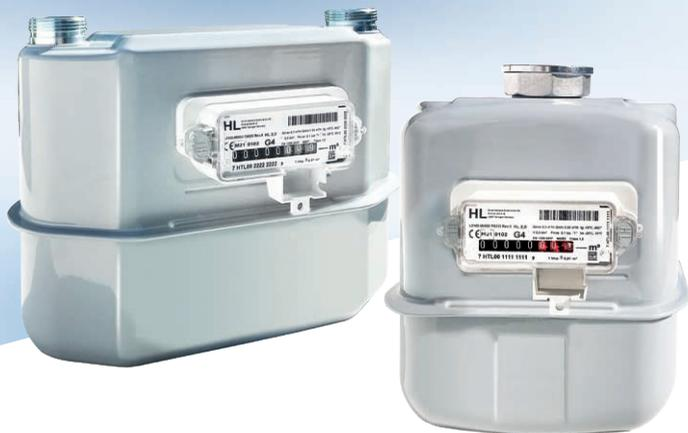
Die Haushaltsbalgengaszähler der Serie HL 2.0 und HLT 2.0 dienen der Erfassung des Betriebsvolumens bzw. des temperaturkompensierten Gasvolumens und können für Erdgas, Luft, Propan, Butan, Stickstoff, Erdgas-Wasserstoffgemische sowie alle nicht aggressiven Gase (nach DVGW G260) eingesetzt werden.
