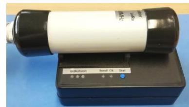
Drehen Sie den 2K-Funksender nach Vorn oder Hinten um seine Längsachse bis eine der 3 Indikator-LEDs leuchtet. Vermitteln Sie die Ausrichtung um die Längsachse so, dass diese LED in beiden Drehrichtungen den gleichen Abstand hat um sicher zu leuchten.
