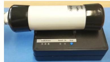
Schieben Sie jetzt den 2K-Funksender entlang der Längsachse bis die Grüne Indikator-LED sicher leuchtet. Vermitteln Sie auch hier die Ausrichtung in der Längsachse.
