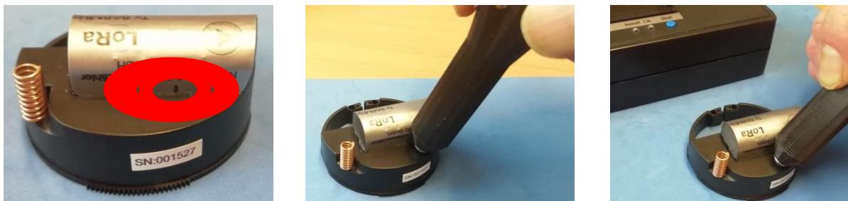
Auf dem Beschriftungsetikett ist ein kleiner schwarzer Pfeil aufgedruckt. Im Winkel von 90° zu dieser Gehäusekante in Richtung des Pfeiles ca. 7mm, Abstand ca. 2mm von der Gehäuseaußenkante den Tastkopf, des am Aktivierungsgerät angesteckten Kabels oder die Tastspitze des Aktivierungsstifts möglichst Senkrecht auflegen.
