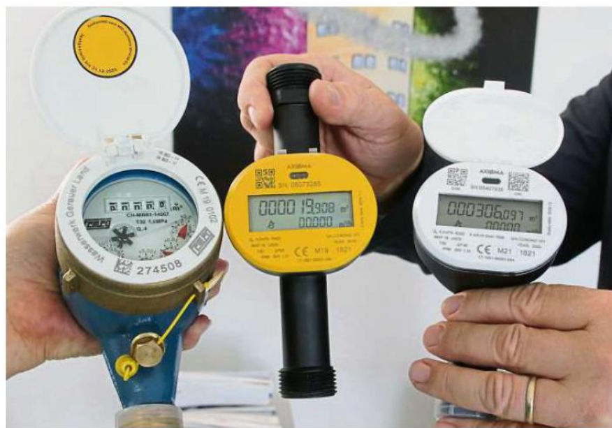
Der mechanische Wasserzähler (links) ist ein Auslaufmodell. Wesentlich genauer arbeiten elektronische Wasserzähler, die Ultraschall einsetzen. Foto: Ralph Keim
