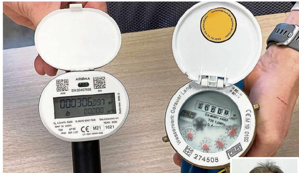
Die neuen Funkzähler (links) lösen beim Wasserwerk Gerauer Land die mechanischen Zähler ab. Für Betriebsleiter Martin Wurzel bietet die neue Technik viele Vorteile. Fotos: Jörg Monzheimer
